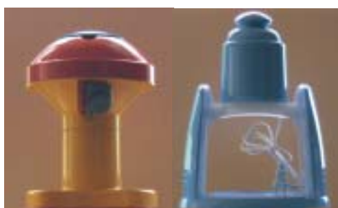
写真2 氷点槽製作に使用する家庭用かき氷機
