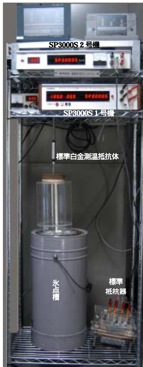
写真 1 氷点槽による温度校正システムの外観 -0.0025 を \pm 0.0005 の再現性で実現
