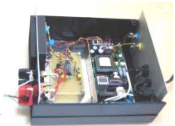
写真 5 簡易白金測温抵抗体用温度計測器
