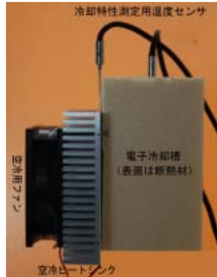
写真3 強制空冷ヒートシンクによる電子冷却槽の外観
