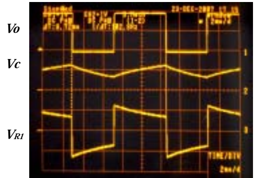
図23 湿度センサ印加電圧波形の実測例
