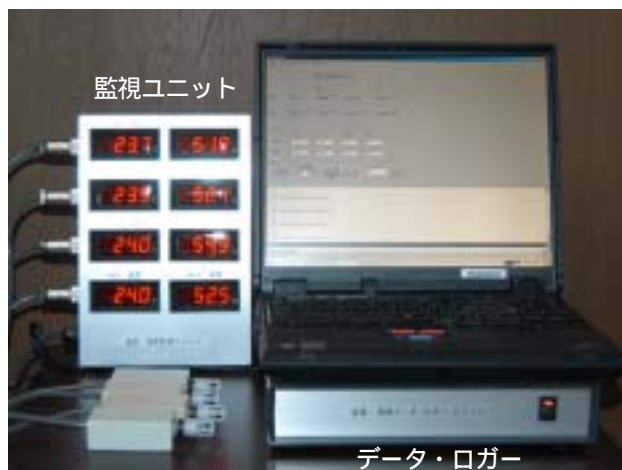
写真2 製作した温度・湿度計測システム
