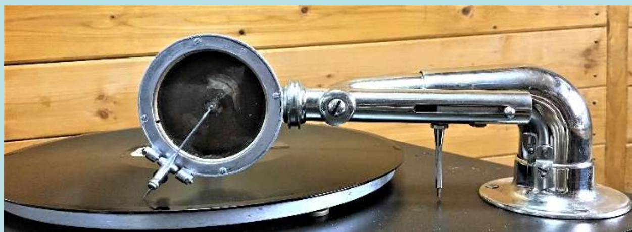
サウンドボックスを垂直にして横振動レコードを再生
