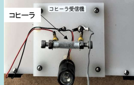
ヘルツの電磁波の発見(1888)再現実験
