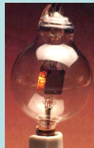
三極管の記号 ドフォーレ3極管の外観
