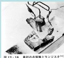
図 12・18 最初の点接触トランジスタ<sup>34)</sup>
