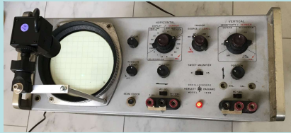
CRTを用いた電子による回折像の実験装置
