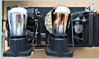
UV-201A(RCA) 2球によるシンプルな回路
