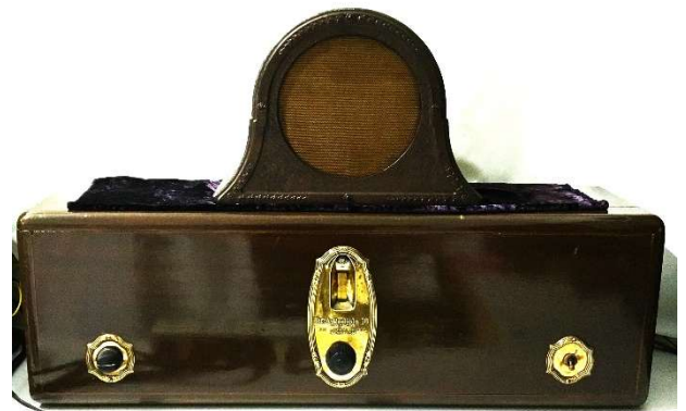
ストレート方式ラジオの完成形 RCA Radiola 18(1928年)
