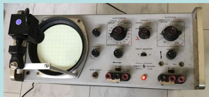
CRTを用いた電子による回折像の実験装置
